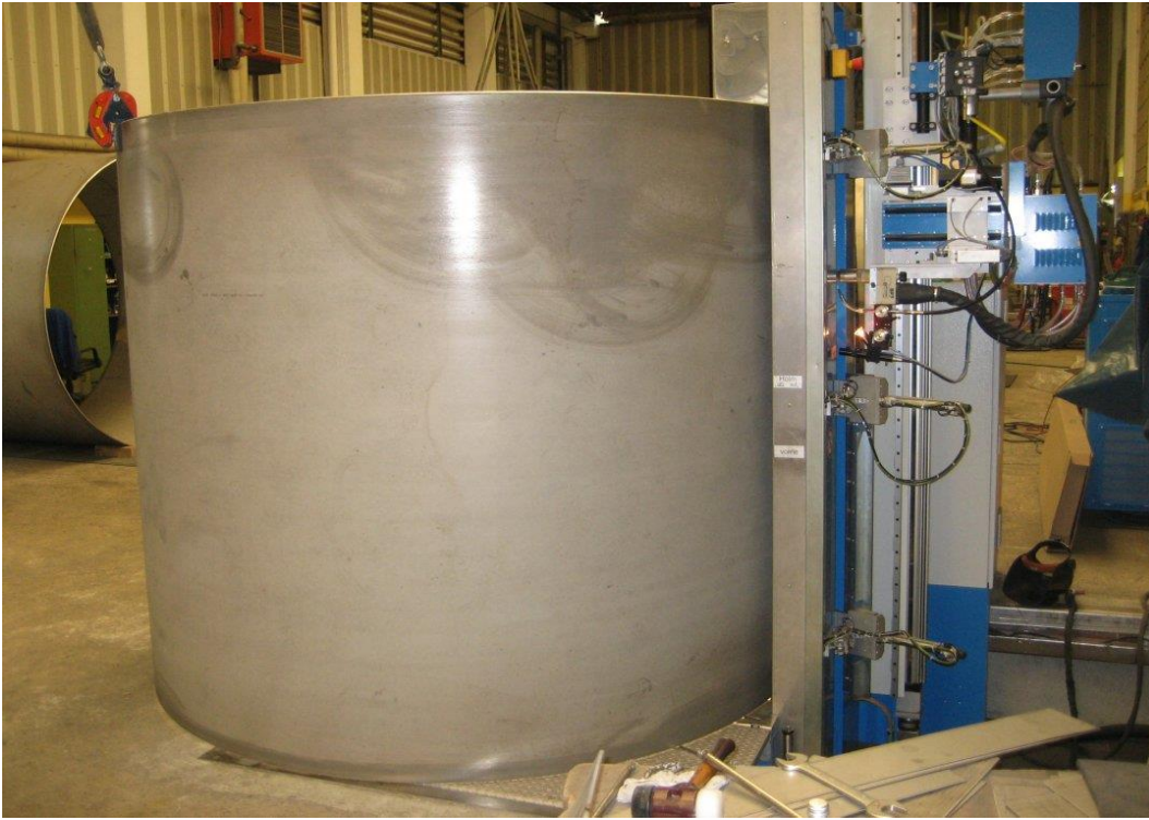
Abbildung 2: Einsatz LINEARWELD VTCL im Behälterbau
