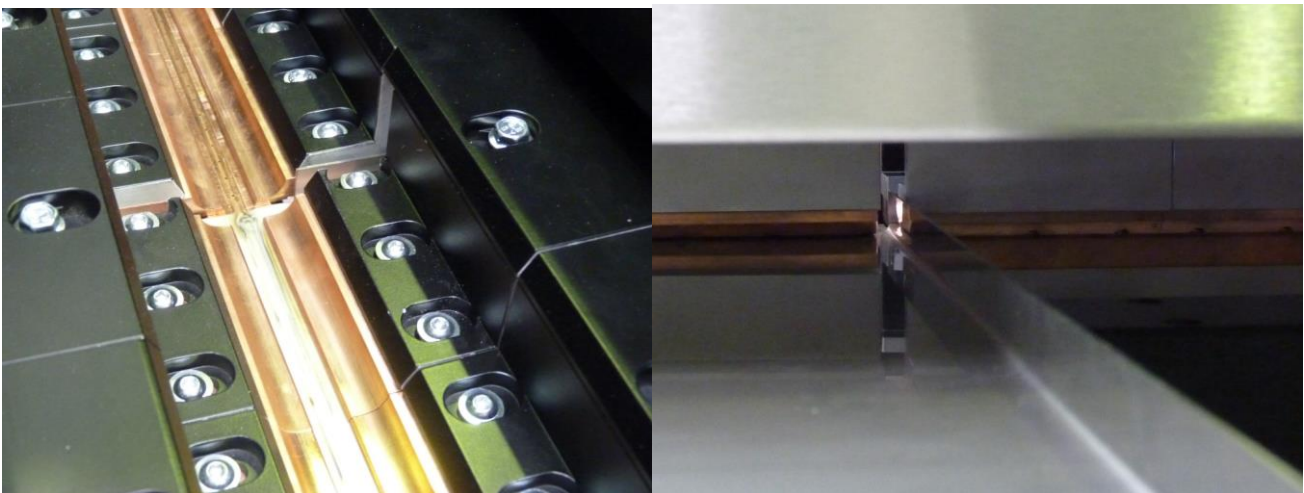
Abb. 7: Außenspannfinger mit verstellbarer Aussparung für Befestigungsflansch.
